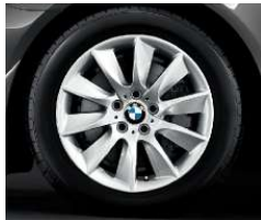
BMW 경합금 휠 터빈 스타일 329 전륜에는 8 J x 18 인치 휠과 245/45 R 18 런플랫 타이어, 후륜에는 9 J x 18 인치 휠과 275/40 R 18 런플랫 타이어가 장착됩니다.
