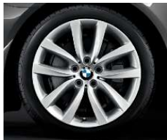
BMW 경합금 휠 V 스포크 331 전륜에는 8.5 J x 19 인치 휠과 245/40 R 19 런플랫 타이어, 후륜에는 9 J x 19 인치 휠과 275/35 R 19 런플랫 타이어가 장착됩니다.
